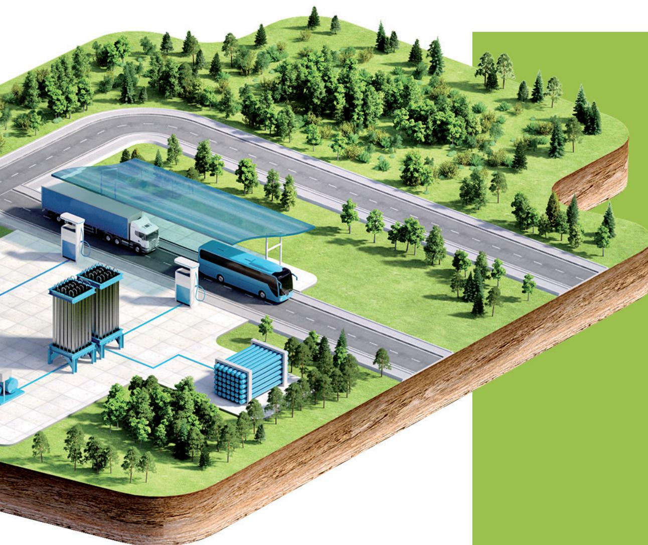
На данном этапе природный газ находится в газообразном состоянии под давлением 250-300 бар. После испарителя высокого давления газ направляется к газозаправочной колонке и производится отпуск газа потребителю. Комбинированная станция может быть укомплектована дополнительными резервуарами высокого давления.
